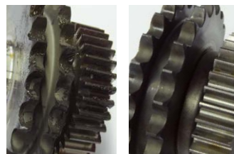
Abreinigen von Öl und Spänen
