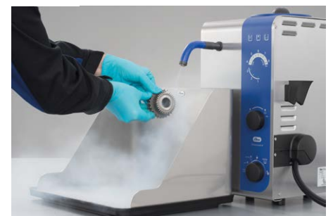
Reinigen in der Abdampfschale Feuchtigkeit und Verschmutzung werden in der Abdampfschale aufgefangen.
