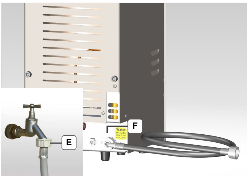
Figure 4.4.3: tuyau à eau raccordé
