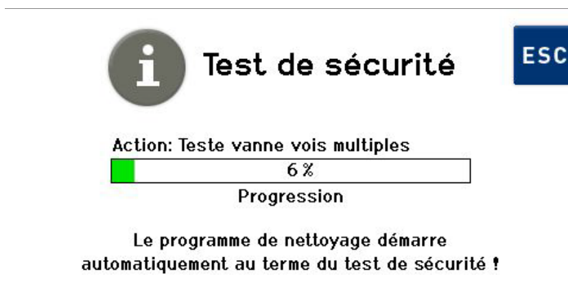
Fig. 6.3.3 Écran Progression du test de sécurité
