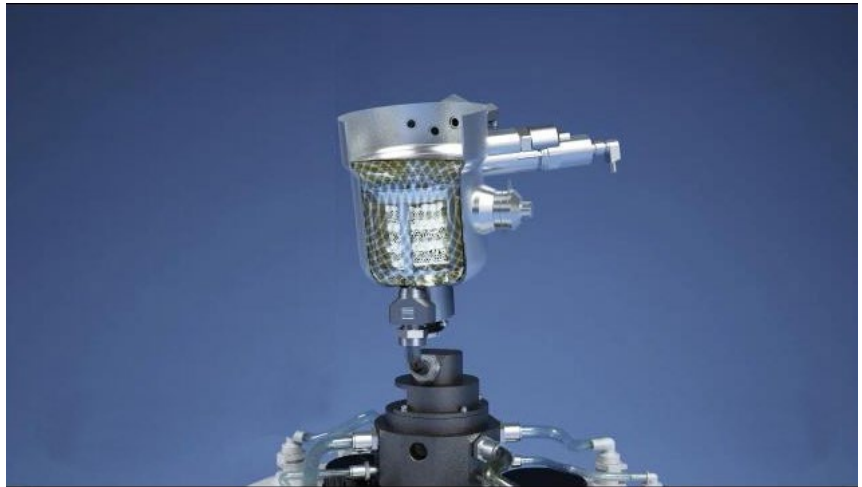
Fig. 3.1.2 Représentation du panier de nettoyage dans la chambre de nettoyage
