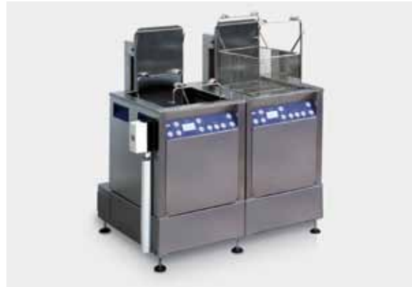
Manuelle 2-Kammer Anlage mit Oszillation
